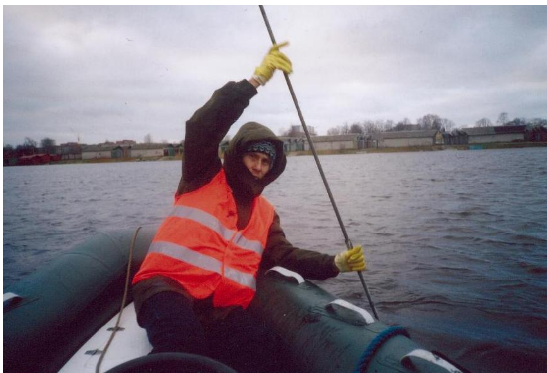
Attēls Nr. 1 Dziļuma mērīšana stacijā ar futštoka palīdzību.
